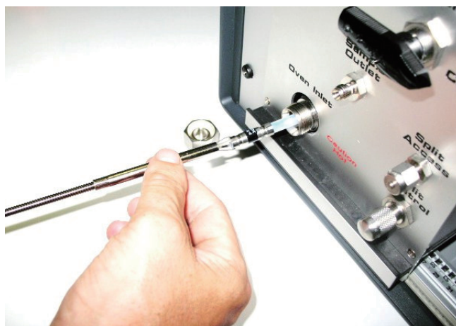
图9 请使用系统附带的专用工具来取出渗透管
